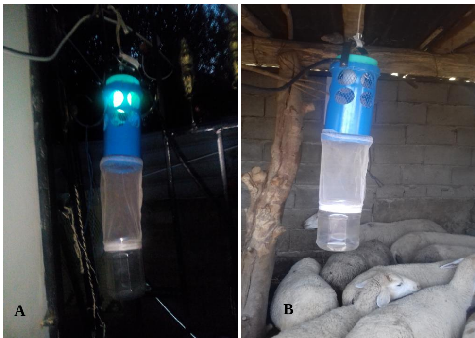
Figure 24 : Piège lumineux de type CDC ; A- en milieu urbain, B- en milieu rural (photos originales).
