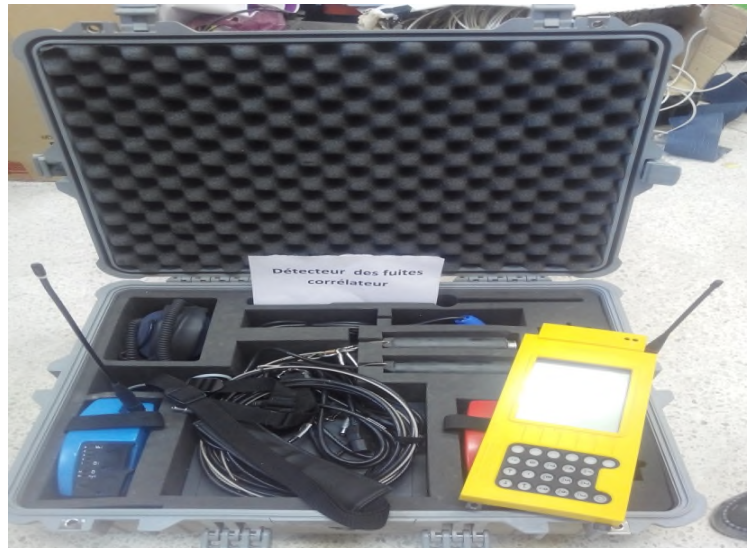
Figure N° IV.11 : Détecteur des fuites corrélateur
