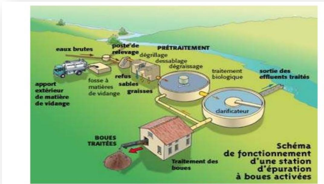
**Figure N°16 :** Représentation d'une station d'épuration domestique : vue d'ensemble
