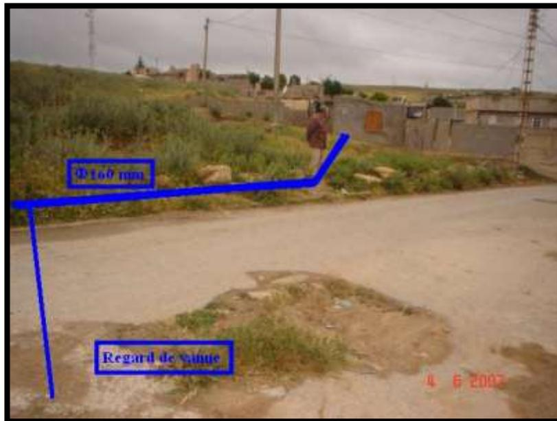
Figure(II.16) : Constructions illicites réalisées au dessus du réseau de distribution.
