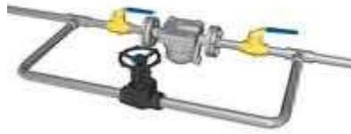
Figure (V.2): Conduit by-pass
