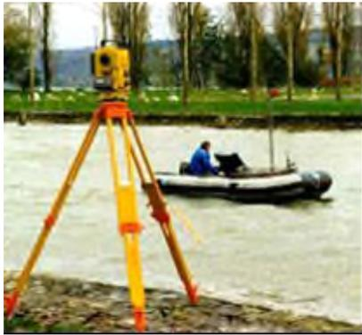
**Figure(2.8):** Estimation de l'envasement par la méthode de nivellement (Tachéomètre).
