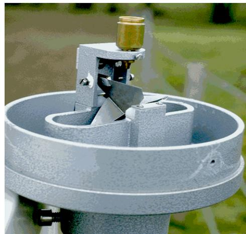
**Fig.5. : Pluviographe, augets basculeurs et système d'enregistrement MADD.**
