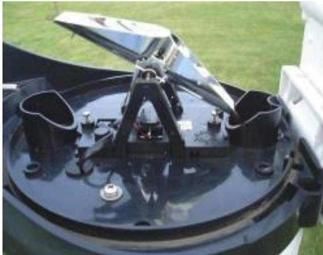
**Fig.3. pluviomètres à auget basculeur**
