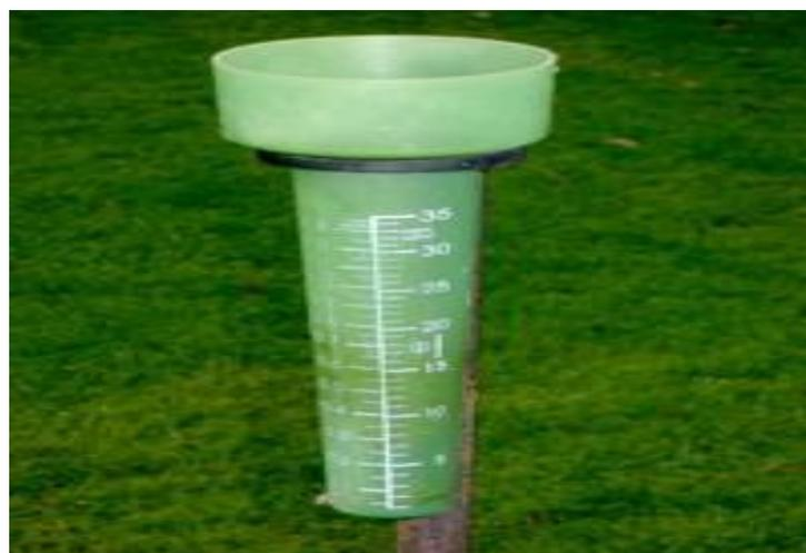
**Fig.2. Pluviomètre à lecture direct**
