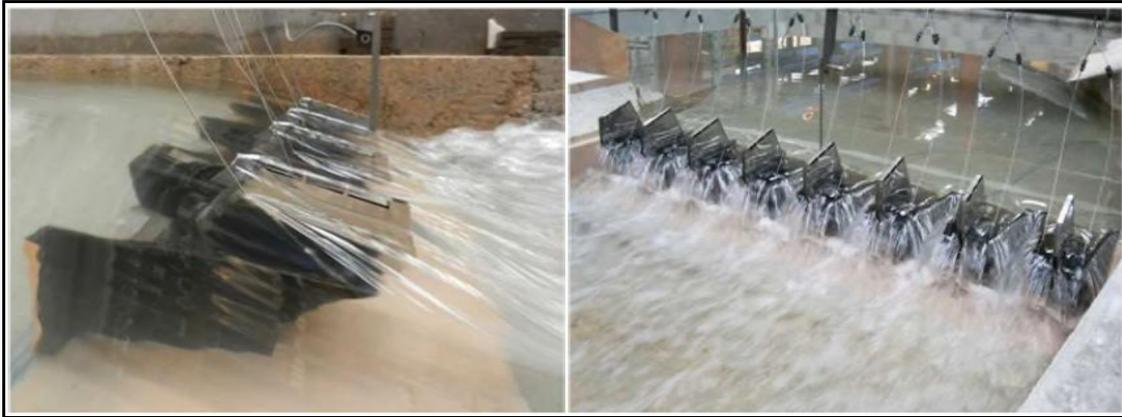
**Figure I.12 :** Essai sur modèle réduit au laboratoire (hausses fusibles) d'Artelia Environnement (Grenoble) « Alberto Gonzalez ».
