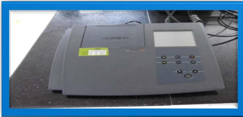
**Photo 19: Oxy-mètre (INOLABO-OXI 730 WTW) (STEP, 2017).**
