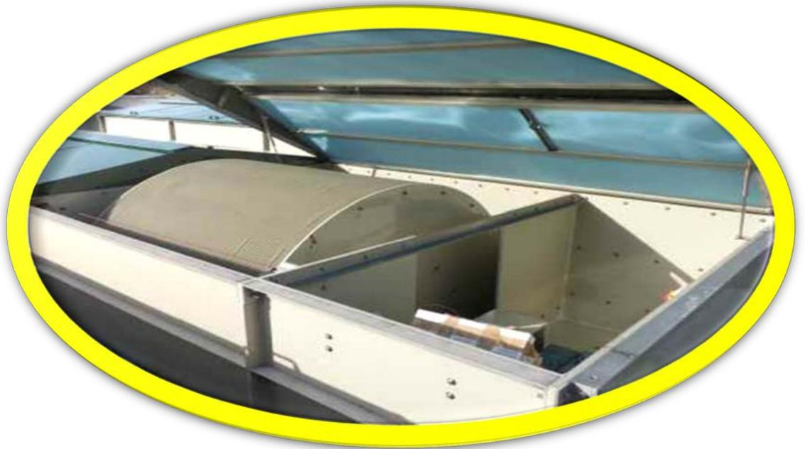
Photo 11: Exemple de station à disque biologique
