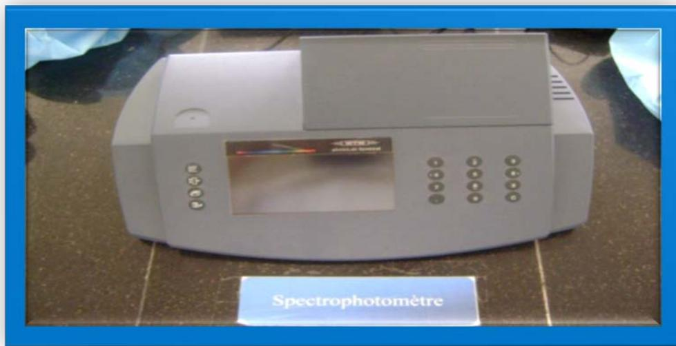
Photo 21: Spectrophotomètre
