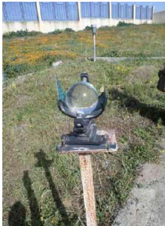
L'héliographe de campbell-stokes mesure l'insolation.
