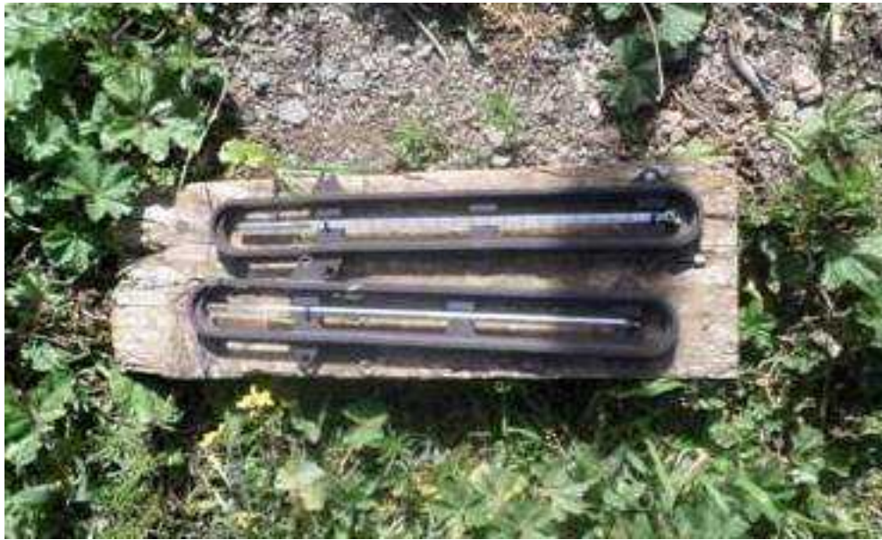
Thermomètre mesuré sous sol.
