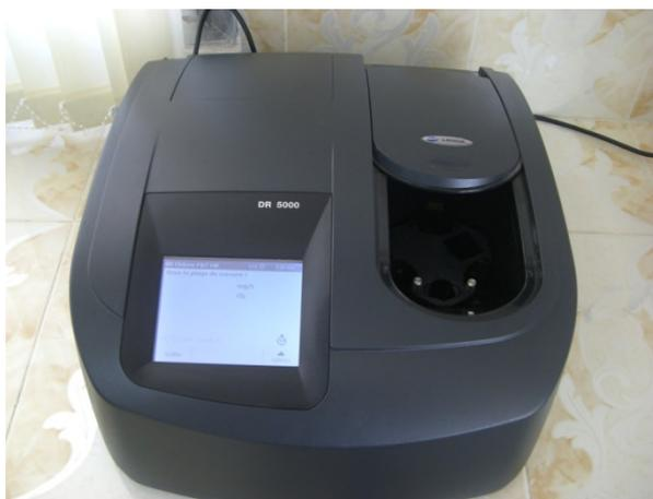
► **Figure 19 : Spectromètre**
