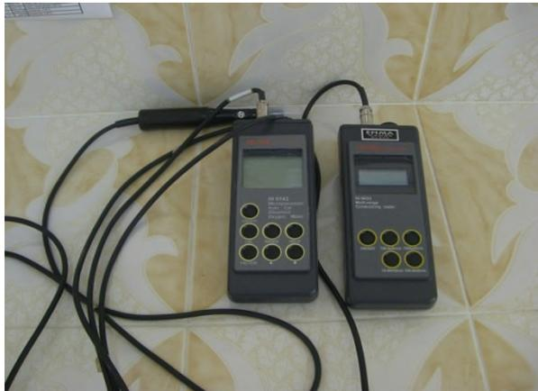
► **Figure 18 : Conductimètre**
