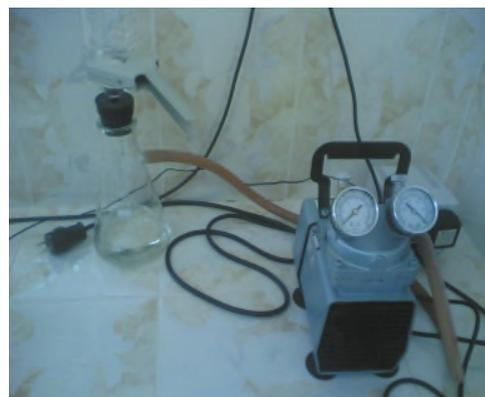
► **Figure24 : Appareil de filtration sous vide**
