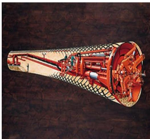
Fig. I.4.1 Creusement avec tunnelier
