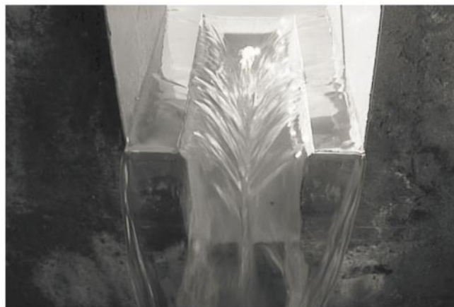
Photo 8 : Ecoulement en deux nappes déversantes sur un cycle de P.K.Weir
