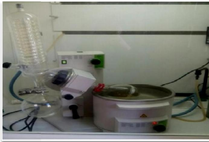
**Figure 12:** Evaporation des échantillons à 60°C.
