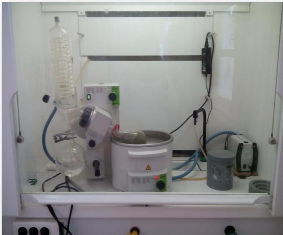
Figure n°14: L'évaporation sous vide des extraits au rota vapeur
