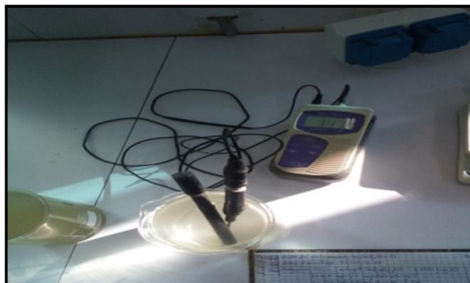
**Figure 17.** Mesure d'oxygène dissous à laide d un oxymètre.
