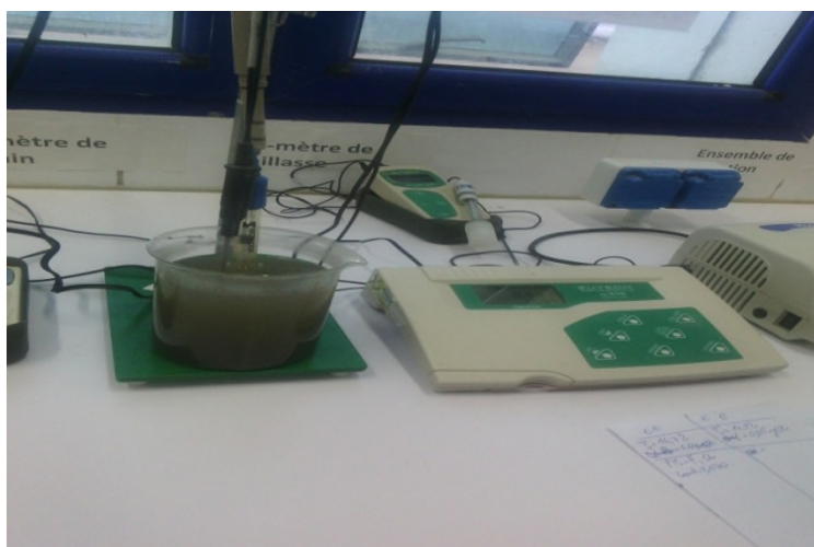
Figure 11 : mesure de PH à l'aide de PH mètre (photo personnel, 2017).
