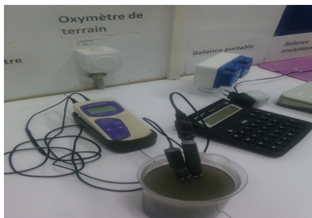
Figure 13 : mesure d'Oxygène dissous à l'aide d oxymétrie (photo personnel, 2017).
