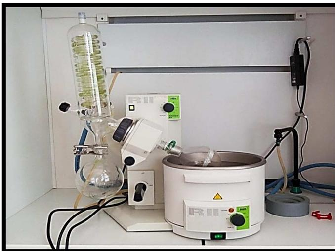
Photo N° 12 : L'évaporation du filtrat à l'aide d'un rotavapor.
