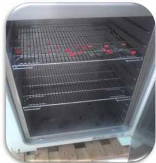
**Figure 27 :** le séchage des lames dans l'étuve
