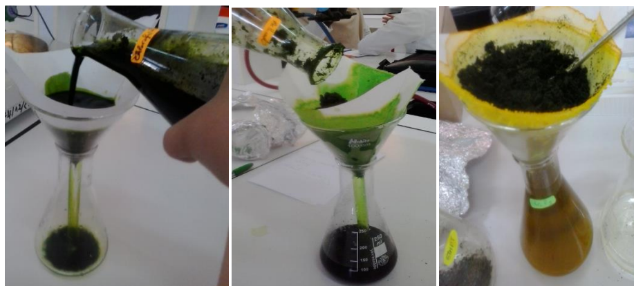
Figure n°18 : La technique de filtration des extraits organiques (E. Chl, E. MéOH, E.EP).
