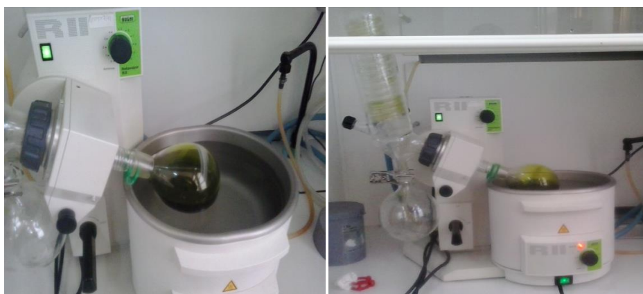
Figure n°19 : la concentration sous vide des extraits au rotavapor
