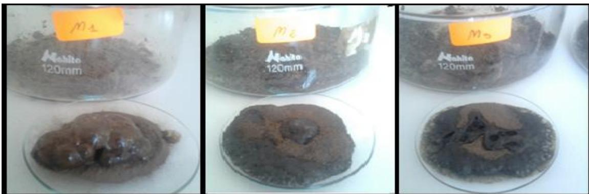
**Figure24:** la puissance de l'effervescence pour détecter la présence ou l'absence de calcaire.
