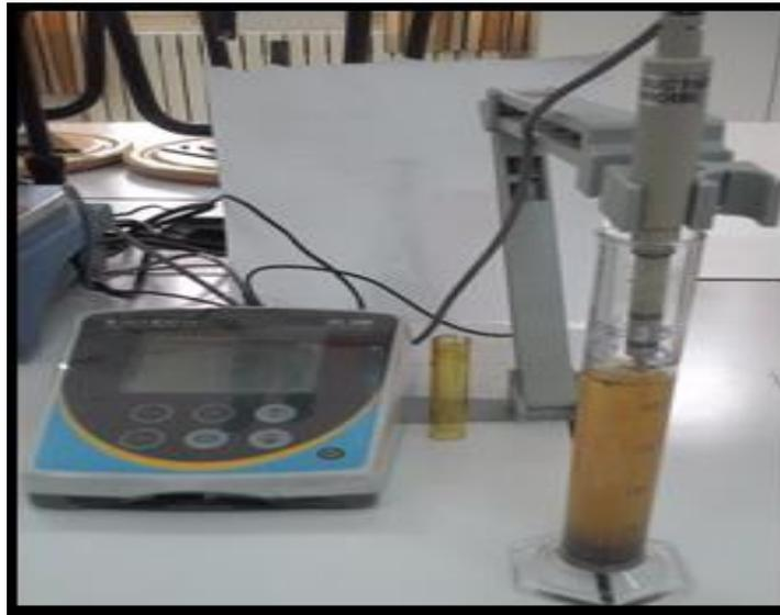
**Figure23:** Le conductimètre.
