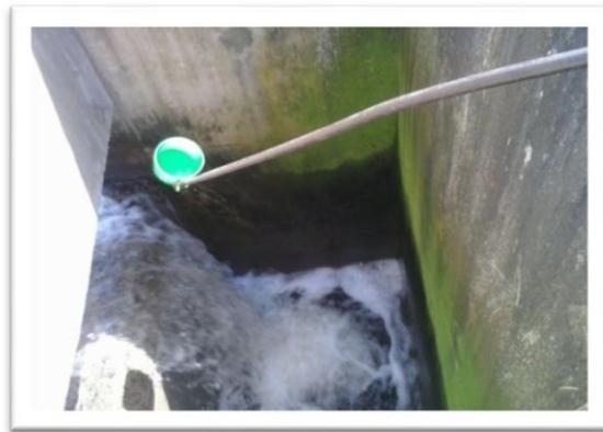
**Figure 16:** prélèvement après dégrilleurs fins    **Figure17 :** prélèvement à la sortie de l'eau
