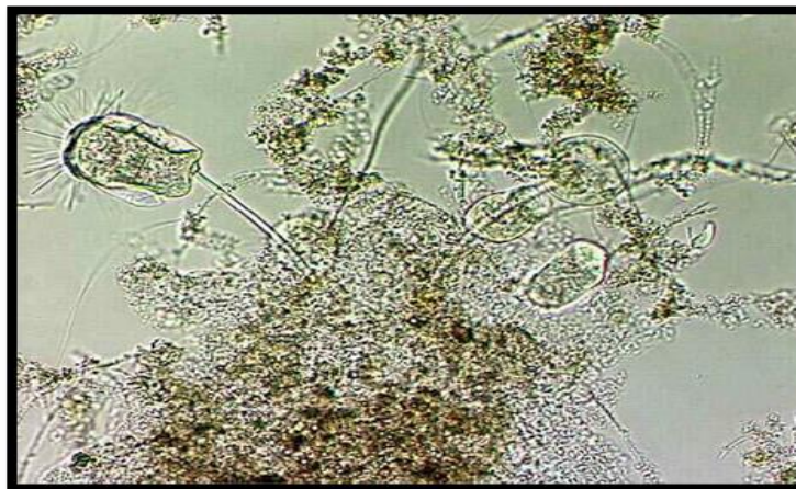
Figure n°05 : Illustration de boues activées et de ses différents composants ( Lacroix, 2008 ).
