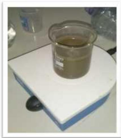
**Figure 4** : Agitateur magnétique
