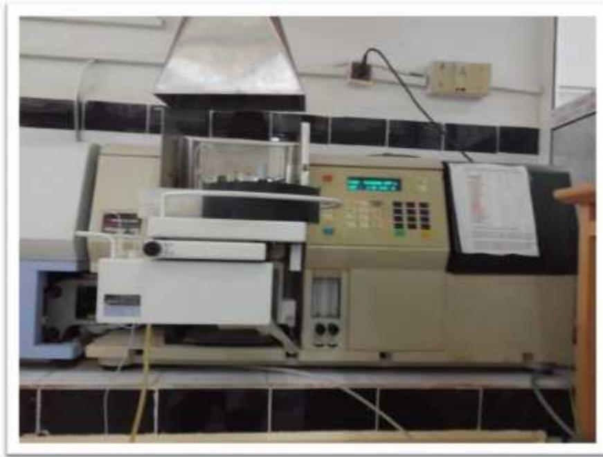
**Figure 6:** photo de spectrophotomètre d'absorption atomique.
