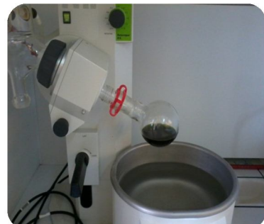
تبخير المحلول المستخلص باستعمال جهاز Rotavapeur التبخير الدوراني
