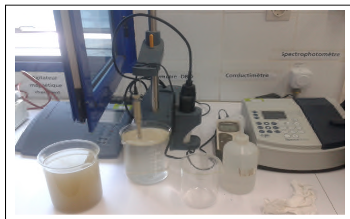
Figure 11 : La mesure de la conductivité (conductimètre)
