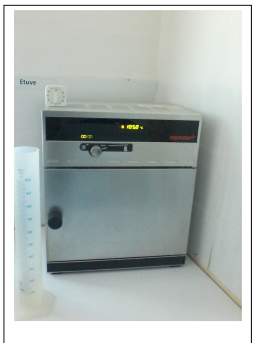
Figure16 : L'étuve à 105 °C.
