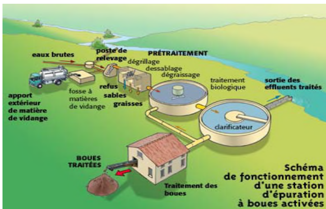
Figure : Organisation d'une station d'épuration à boues activées.
