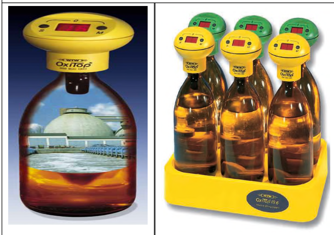
Figure18 : Représente le système Oxitop® pour la mesure de DBO5.
