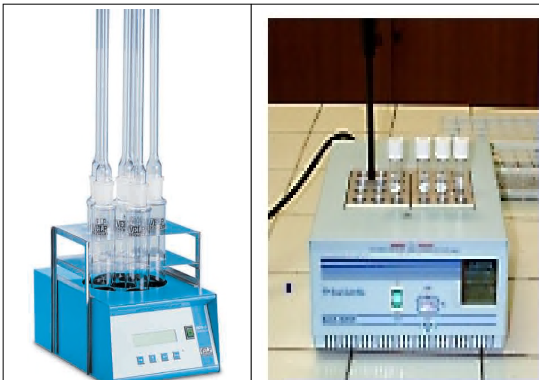
Figure17 : Réacteur de DCO.
