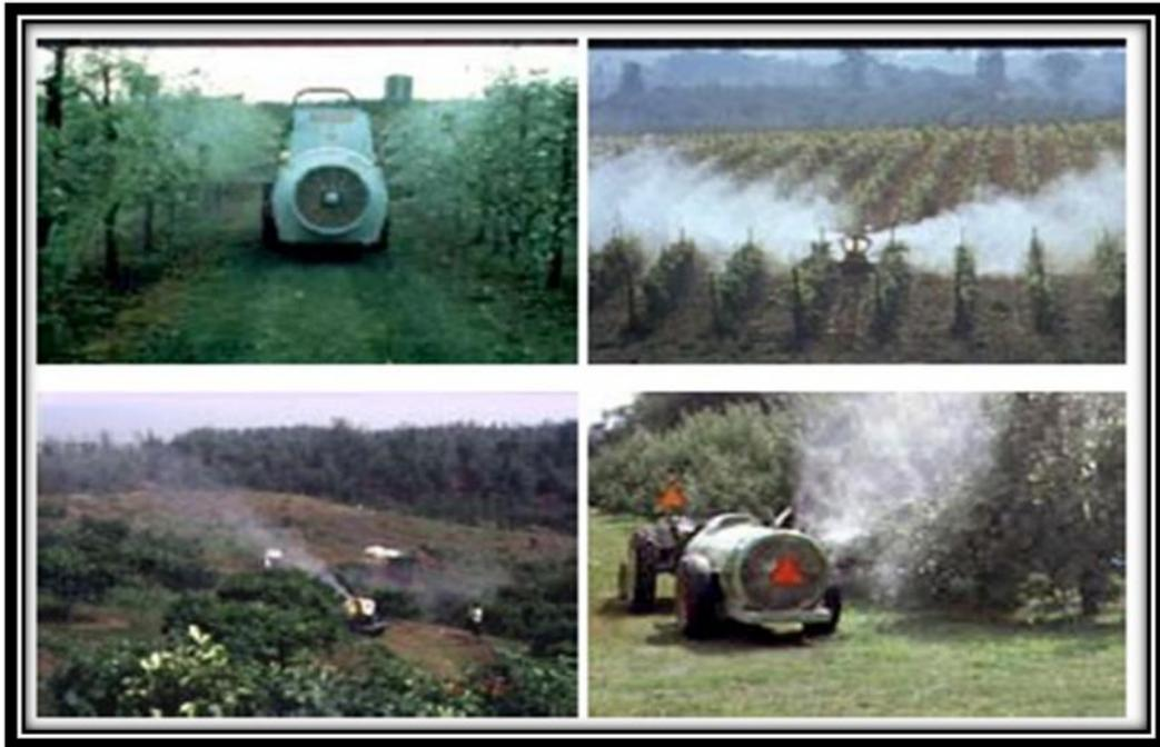
**Figure 1:** Dérive impliquée par un ventilateur pulvérisant [**Cross et al., 2001**].
