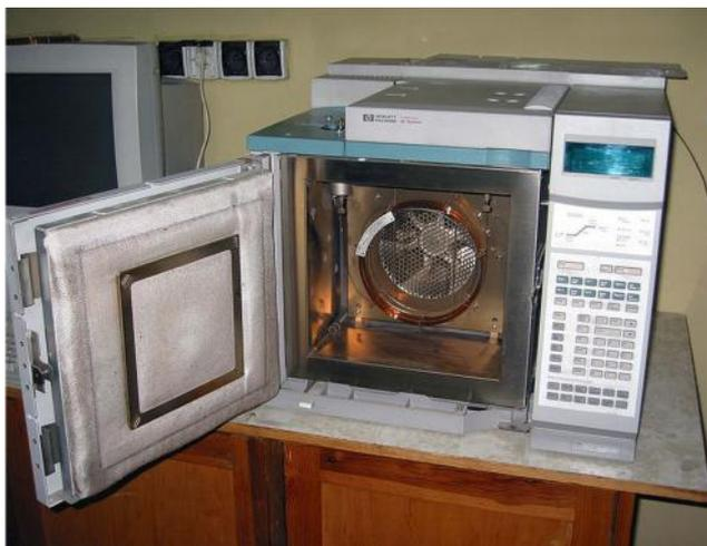
**Figure 18: La chromatographie en phase gazeuse (CPG)**
