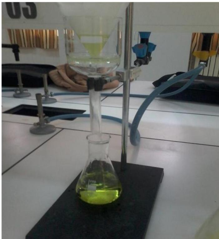
**Figure 13** : séchage la phase organique par ( $\text{Na}_2 \text{SO}_4$ )
