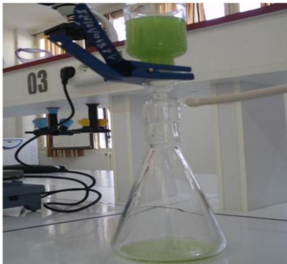
**Figure 12:** Filtration de homogénat sous faible pression dans un entonnoir de Buchner
