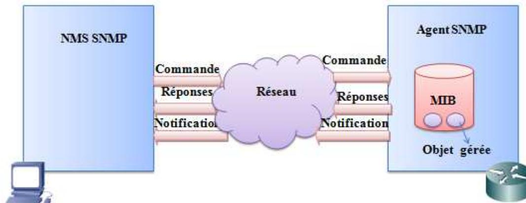
Figure 1.6 : Architecture SNMP
