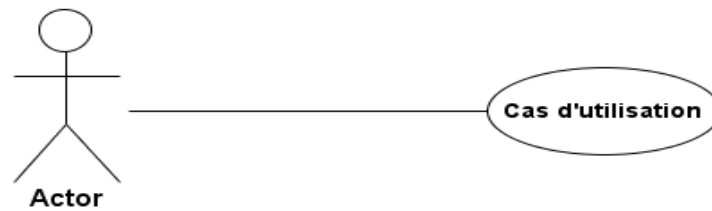
Figure 2.3: Exemple d'un diagramme de cas d'utilisation.
