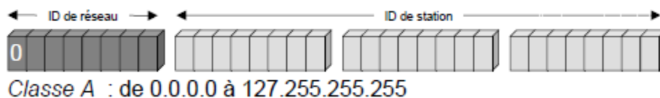
Figure 1.3 : Le format des adresses IPv4 de la classe A [2].
