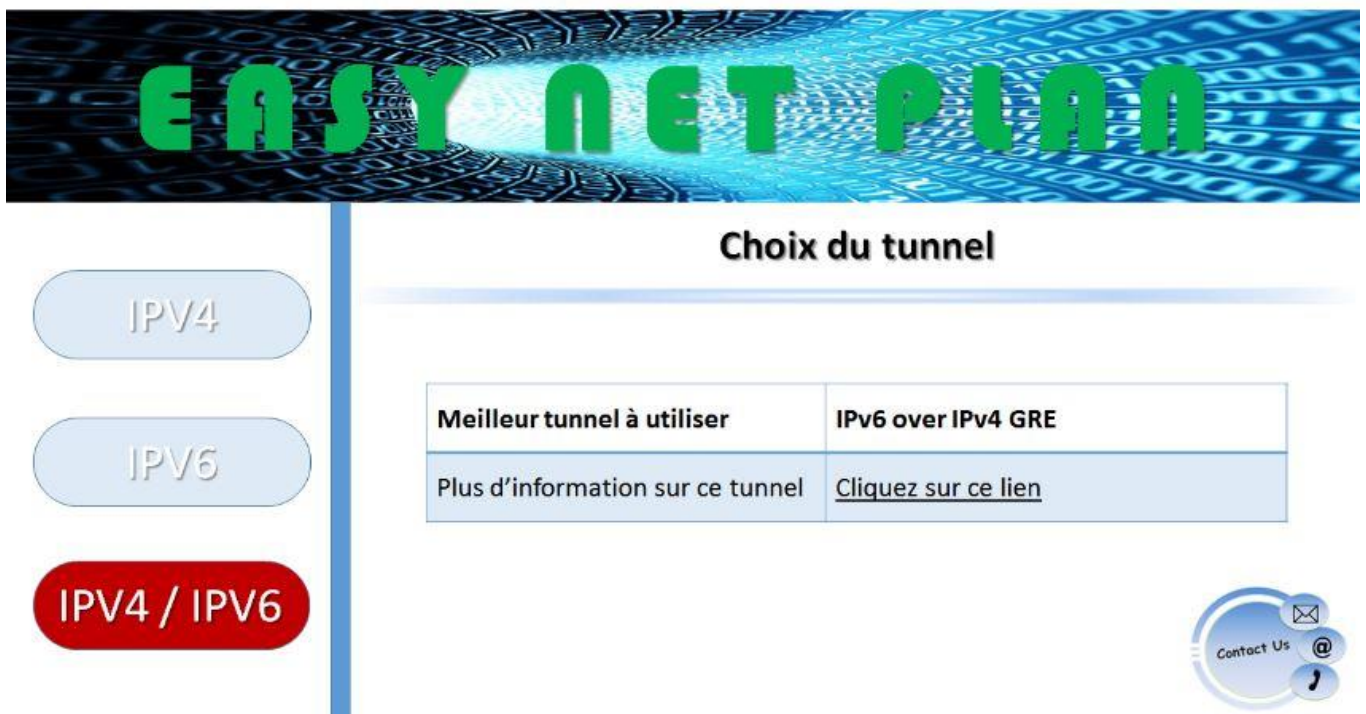
Figure 2.11 : Exemple d'une assistance au choix des tunnels.
