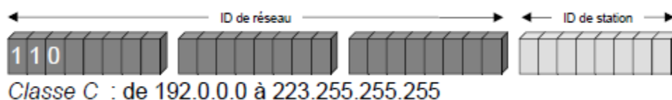
Figure 1.5 : Le format des adresses IPv4 de la classe C [2].
