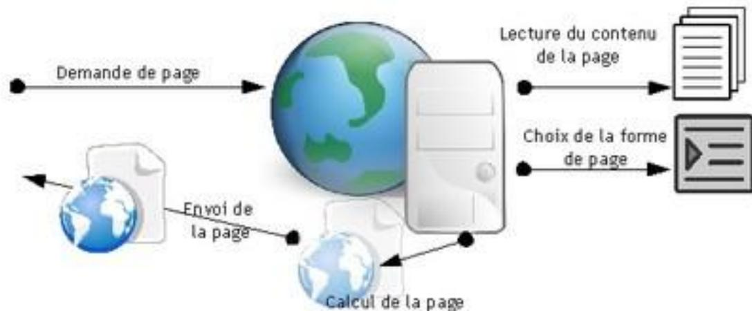
**Figure4 : Le fonctionnement d'un site web dynamique**
