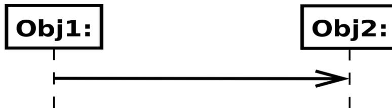
Figure 2.9: Représentation d'un message asynchrone.
